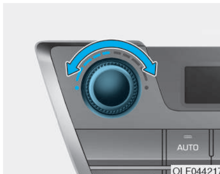
۲. دکمه مدور دما را بچرخانید تا در دمای دلخواه تنظیم شود.
